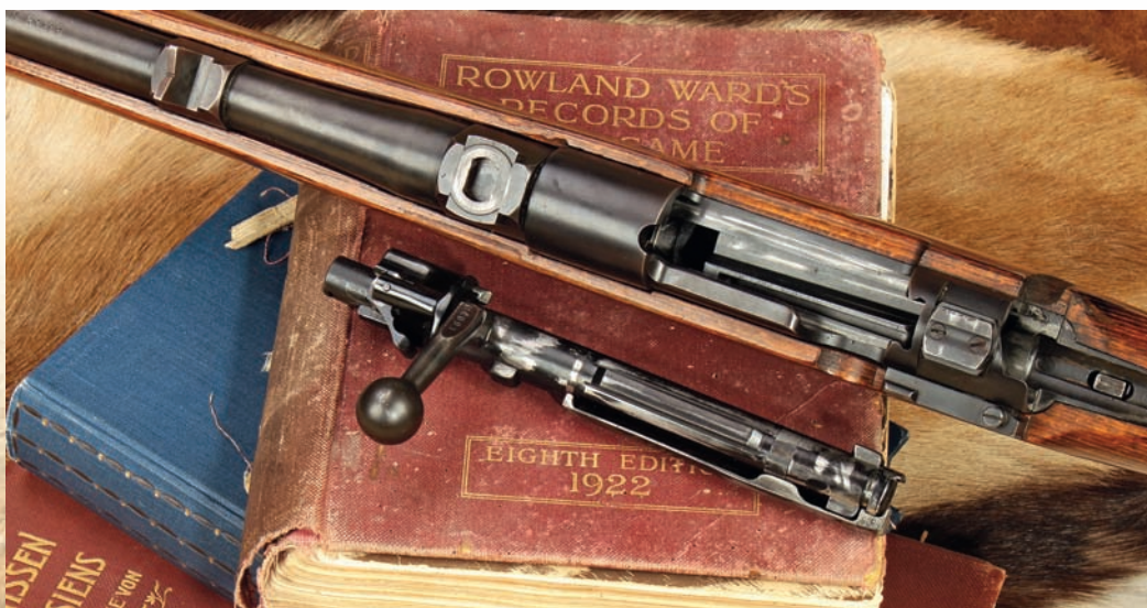
Für den massiven 98er Verschluss stellt das Kaliber .375 Holland & Holland noch keine große Herausforderung dar. Die üblicherweise hinten am Schlüsschen liegende Sicherung wich einer seitlich angebrachten. Für Nachsuchen im Busch entfernt Baldus in der Regel das Zielfernrohr.
